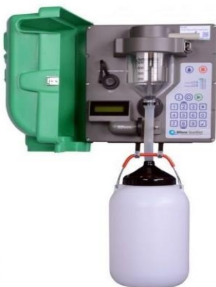
BQD-A-T1 con recipiente de recogida de muestras HDPE de 10 litros y soporte de suspensión opcional
